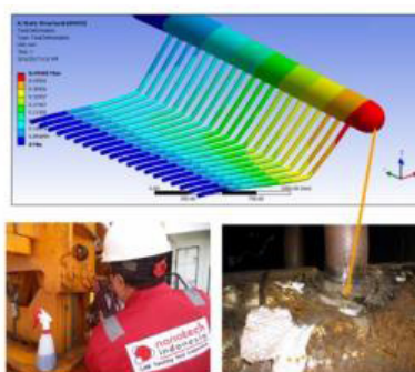
Pengujian Identifikasi Material di Lapangan Positive Material Identification (PMI)
